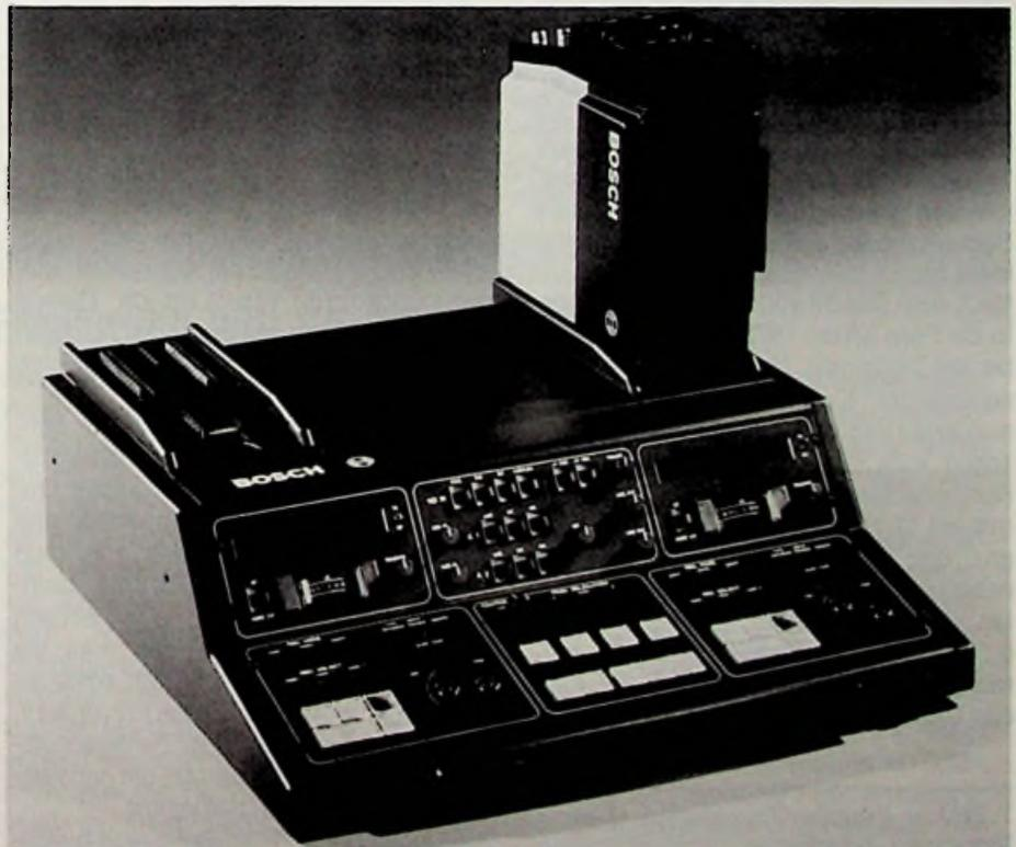
**Bild 4:** Bearbeitungsanlage für die Recorder der KBF1 mit zwei Recorderaufnahmen
