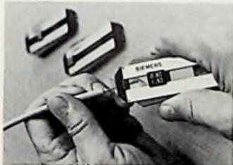
die Zentrierung viel höhere Anforderungen gestellt werden als beim Abisolieren herkömmlicher Kupferkabel, wendet Siemens zur Fertigung der maßgenauen halbkreisförmigen Messerschneiden ein spezielles Funkenerosionsverfahren an. Das nur etwa 40 Gramm schwere Werkzeug ist mit Messeröffnungen von 0,25, 0,60 und 0,80 mm bei allen deutschen Siemens-Geschäftsstellen erhältlich; der Listenpreis beträgt 82,- DM. Die drei genannten Durchmesser entsprechen dem derzeitigen Stand auf dem LWL-Markt.
