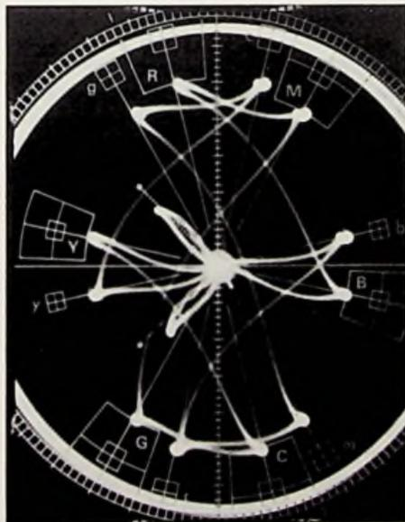
**Bild 10:** Kontrolle der Farbqualität (Farbart, Sättigung u. Phase) an einem Vektorskop mit dem Farbbalken-Signal des VG-1000 (hier: Farbtone korrekt; Farben etwas entsättigt)
