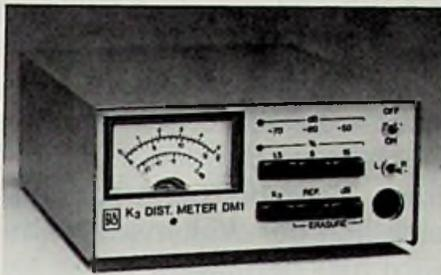
Bild 13: Amplitudenunabhängiges  $K_3$ -Meßgerät (Bang & Olufsen-Presebild)
